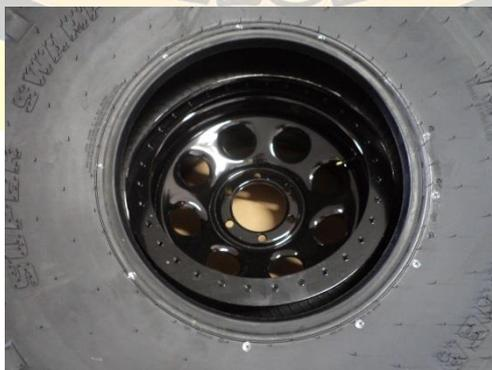
PASSO 4: Centralize o talão externo do pneu na flange externa do beadlock da roda.
