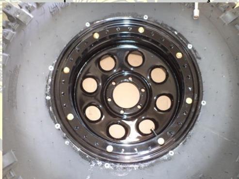
PASSO 7: Instale os 24 parafusos restantes da mesma forma dos 8 primeiros, ou seja até o final da rosca da porca interna de fixação. Verifique se o espaço entre o anel e a roda é uniforme em toda a circunferência interna.
