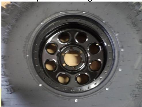
PASSO 5: Aplique pasta de montagem para pneus no talão externo do pneu.
