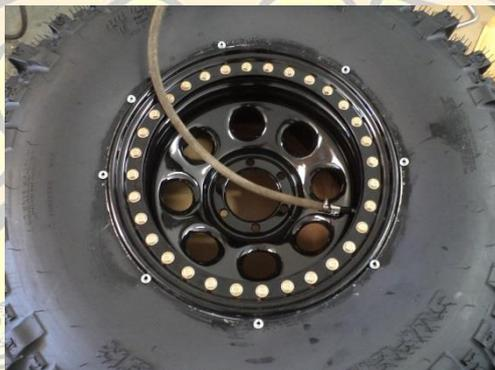
PASSO 10: Após a montagem da roda no veículo rode pelo menos 50 km, desinfe o pneu e verifique novamente o torque dos parafusos fixadores do beadlock, isto é muito importante ser feito para a perfeita montagem final do produto.
