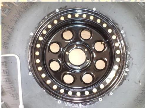
PASSO 8: Utilizando um torquímetro **(NÃO UTILIZAR FERRAMENTAS PNEUMÁTICAS NESTA FASE)** use a sequência de torque em cruz (+) começando por qualquer um dos parafusos, a cada novo nível de 8 torquedados pular para o parafuso seguinte fazendo o mesmo processo em cruz, conforme tabela abaixo:
