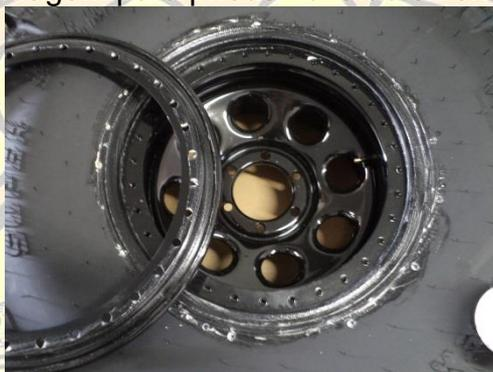
PASSO 6: Pressione firmemente o anel do beadlock contra o talão do pneu e alinhe os furos com o anel interno. Utilize 8 parafusos instalados a 45 graus de distância e fixe o anel. Aperte cada um deles até pelo menos passar a rosca da porca interna de fixação.
